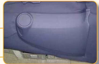
Inyección sobre TPO (tacto blando) para salpicadero
