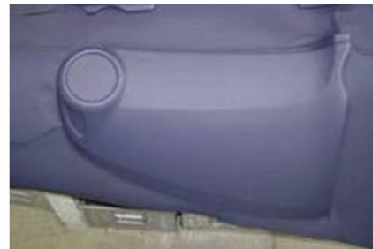
Inyección sobre TPO (tacto blando) para salpicadero
