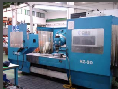
Marca: CME Modelo: HZ-30 Nº serie: 30-313 Características: X=2000, Y=1200, Z=1000
