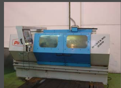
Marca: MUSTANG Nº serie: 9901959 Características: Altura de Punto 200 Anchura de bancada: 300
