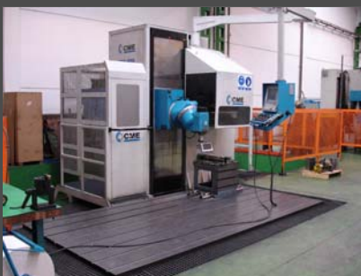
Marca :CME Modelo: FCM-4000 Nº serie: 415 Características: X=4000, Y=1200, Z=1500
